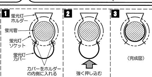
**【SC60-3Dの場合】** 交換ランプの種類 —15W電球色(FL15EX/L)
